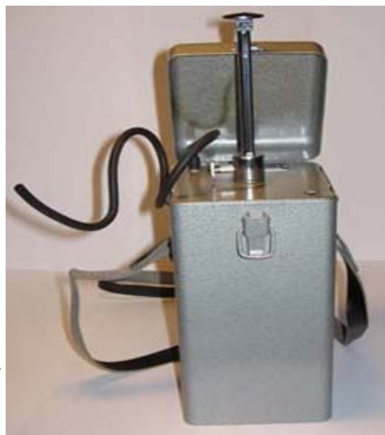
Рис. 8.1 – Універсальний газоаналізатор УГ-2
